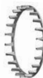
Fig. 7. Cage à ergots en deux parties, usinée en laiton, guidée par la bague intérieure.
