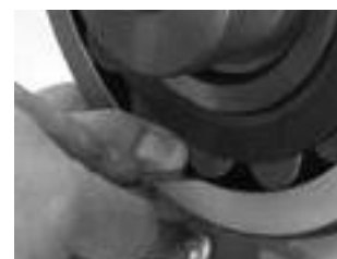
Figure 15. Lors du montage, le jeu interne radial doit être vérifié sur le rouleau déchargé.
