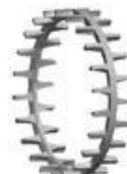
Fig. 6. Cage monobloc à cames ou ergots, usinée en laiton, guidée par la bague intérieure.
