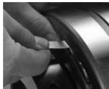
Fig. 18. Mesure du jeu radial interne avant l'installation.
