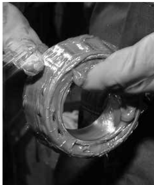
Figure 15. La graisse peut facilement être appliquée à la main.
