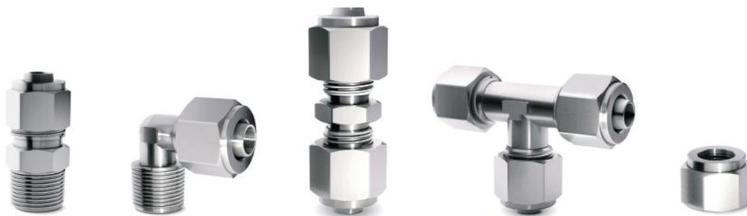
Les raccords à olive Série X1000 peuvent être facilement installés. Les écrous de blocage peuvent être serrés manuellement et avec une clé, même dans le cas de tubes plus rigides comme le PA ou l'Hytre Polyester. La forme du cône de guidage spécial garantit que le tube ne peut pas être coupé accidentellement.
