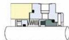
Il est utilisé principalement pour des produits visqueux véhiculés à haute température, jusqu'à 220°C et au-delà avec des joints à base de graphite
