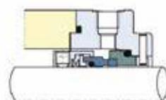
**LATTYseal B 18212** : garniture mécanique à ressort cylindrique, indépendante du sens de rotation
