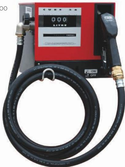
Distributeurs à usage privé pour gasoil. Pompe à amorçage automatique à ailettes pourvue de by-pass, installée sur supports anti-vibrations. Joint mécanique. Moteur d'induction pourvu de protection thermique en cas de surchauffe.
