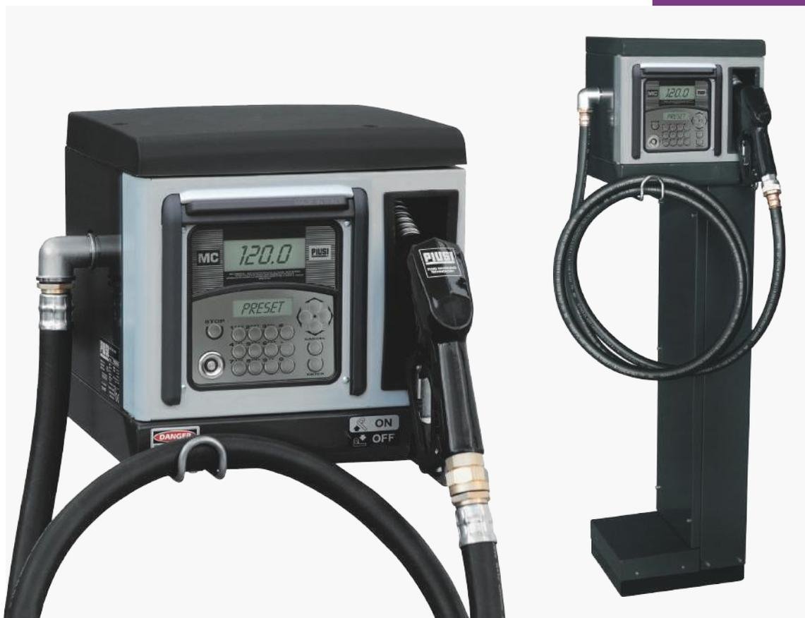
Distributeur à usage privé pour gasoil. Pompe à amorçage automatique à ailettes pourvue de by-pass, installée sur supports anti-vibrations. Joint mécanique. Moteur d'induction pourvu de protection thermique en cas de surchauffe.
